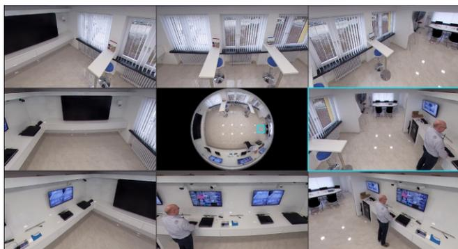
Fisheye Kameras nehmen ein 360°-Bild der Umgebung auf, welches durch die Software wieder in ein entzerrtes Bild umgewandelt wird (De-Warping). Bei der Darstellung kann zwischen verschiedenen Varianten gewählt werden, auch nachträglich beim Abspielen der Aufnahmen. Maximale Überwachung bei kleinstem Installationsaufwand.
