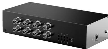
Mit Hilfe des L-MS-2804 wird die Spannung (12 V DC / max. 15,6 W) über das Koaxialkabel eingespeist. Vier PoC-Kameras lassen sich so über eine Strecke von max. 400 Metern mit Strom versorgen. Bei der Verwendung von HD-CVI Kameras ohne PoC, wird der L-SP-2801 benötigt. Die Stromversorgung erfolgt über 12 - 36 V DC. Netzteil 24 V DC / 3 A ist im Lieferumfang. Der L-MS-2804 sollte nicht mit einem PoC-Rekorder kombiniert werden.
