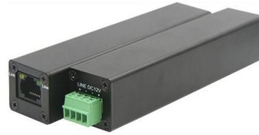
Das L-EPE Set ist ein PoE Ethernet Extender Set. Es ermöglicht die Übertragung von Videosignal und Spannungsversorgung (Ethernet > Zweidraht > Ethernet) über eine Entfernung von bis zu 500m (88Mbps). Hierzu wird das mitgelieferte 48V Netzteil an das Hauptmodul (Rekorderseite) angeschlossen, welches dann das 2. Modul und die PoE-Kamera mit Spannung versorgt. Werden beide Module mit 12VDC betrieben ist eine Übertragungsweite bis 600m möglich (ohne PoE).
