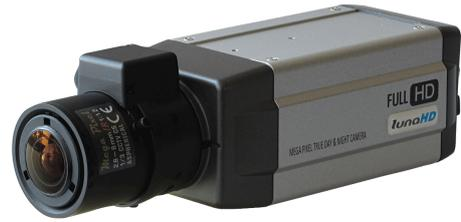
Die L-BD-2501 ist eine HD-CVI Boxkamera. Die CVI-Technik ermöglicht die Übertragung eines analogen Videosignals in FullHD bis zu einer Länge von 500m. Passende Objektive (nicht im Lieferumfang) werden über CS angeschlossen. Der DSP (Signalprozessor) der Kamera ermöglicht zahlreiche Einstellungen für optimale Bildqualität auch bei schwierigen Lichtverhältnissen (OSD über Koaxkabel). Die Spannungsversorgung erfolgt über 12VDC oder 24VAC.
